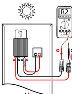
Las sondas están conectadas a la inversa. El valor medido R2 es inferior a la resistencia medida cuando las sondas están conectadas correctamente.
