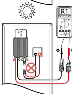
La entrada del optimizador no está conectada:  $1,1 \text{ k}\Omega < R1$
