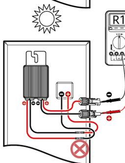
La salida del optimizador está conectada a la salida del módulo PV:  $1,1 \text{ k}\Omega < R1$
