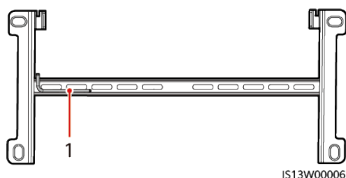
Figura 4-9 Posición para trabar una llave torx de seguridad
