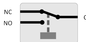
Configuración del relé (sin corriente)
