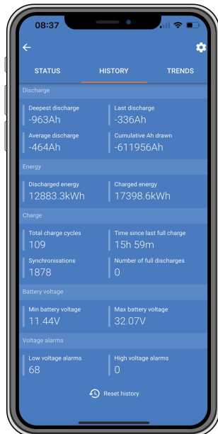
La aplicación VictronConnect mostrando el historial de un monitor de baterías
